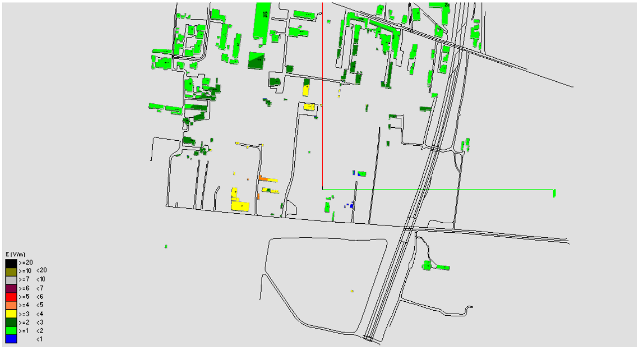
Fig. 23 Impatto elettromagnetico – Zona Isola Ecologica – Vista dall'alto
